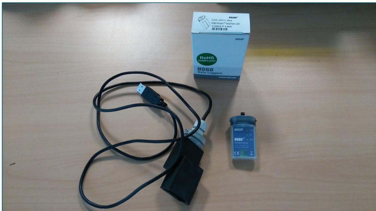
Photographie 1 : Sonde de mesure de la température et sa base de transfert (USB).
