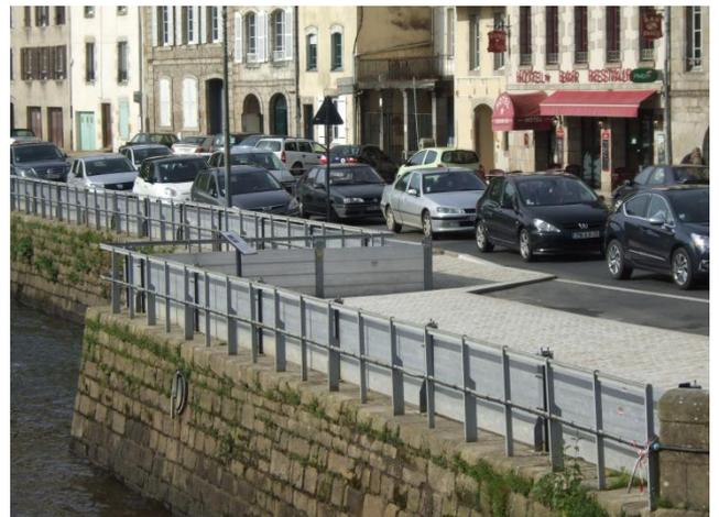
A Morlaix quelques rares commerces ont mis en place à titre individuel un système de batardeaux. Il semble pourtant que de tels équipements d'auto-protection auraient pu être d'une réelle efficacité lors des épisodes récents d'inondations. L'installation de batardeaux de fortune et une action de
