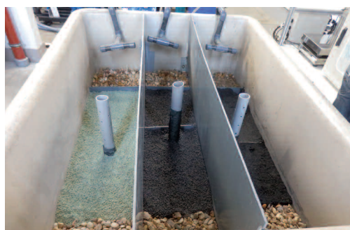
Figure 2. Pilotes garnis de matériaux adsorbants (argile expansée, zéolite et charbon actif).
