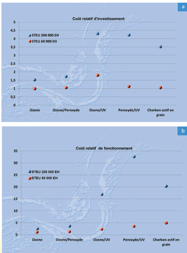
Figure 5. Coût relatif de fonctionnement et d'investissement des différents procédés par rapport à une référence définie par le traitement à l'ozone pour une station de traitement des eaux usées de 60 000 EH.
