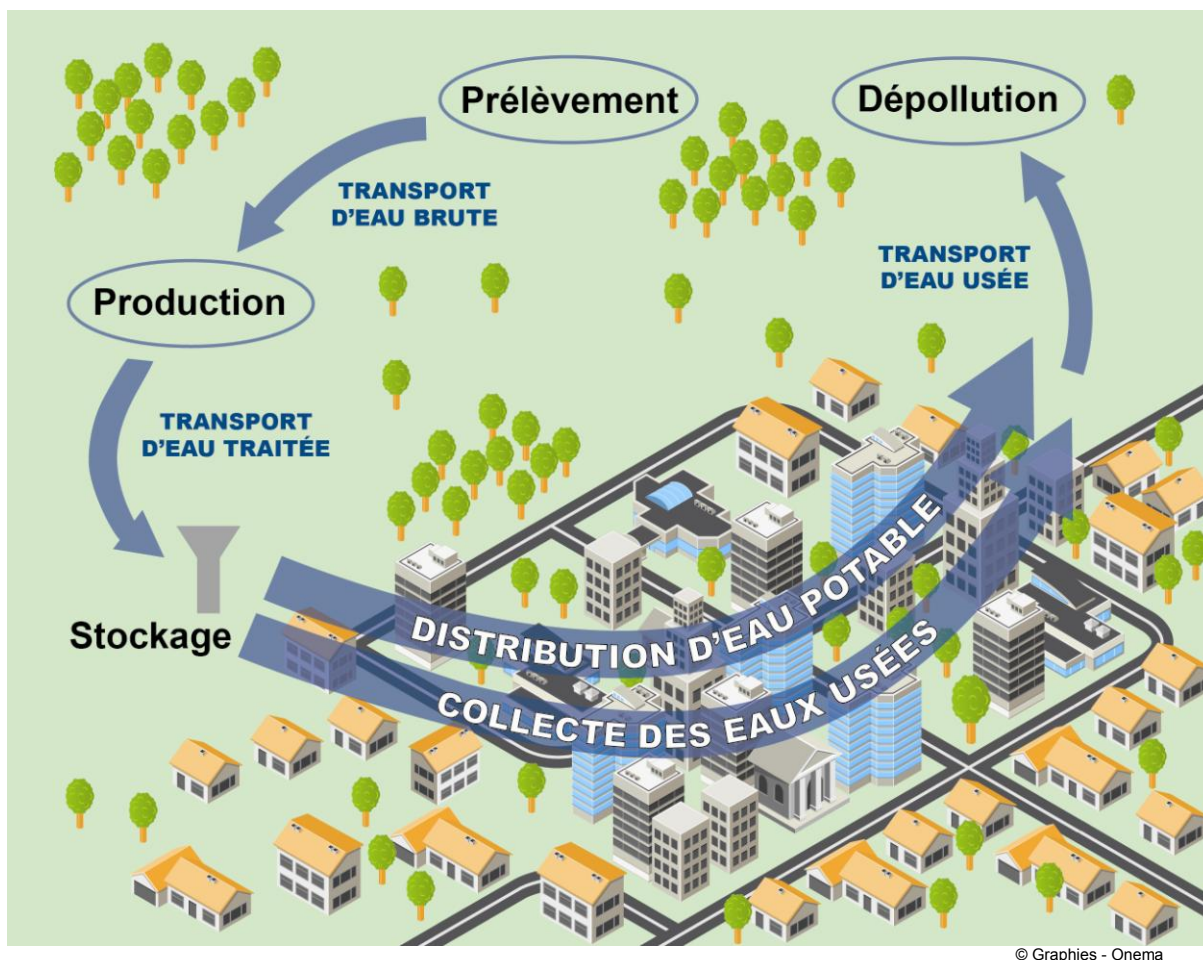
Figure 9 : Schéma des compétences et missions des collectivités en charge de l'eau potable et de l'assainissement collectif
