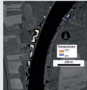
Les RCC montrent un léger gradient thermique longitudinal (~0,05°/km). Latéralement, la variabilité thermique est faible.
