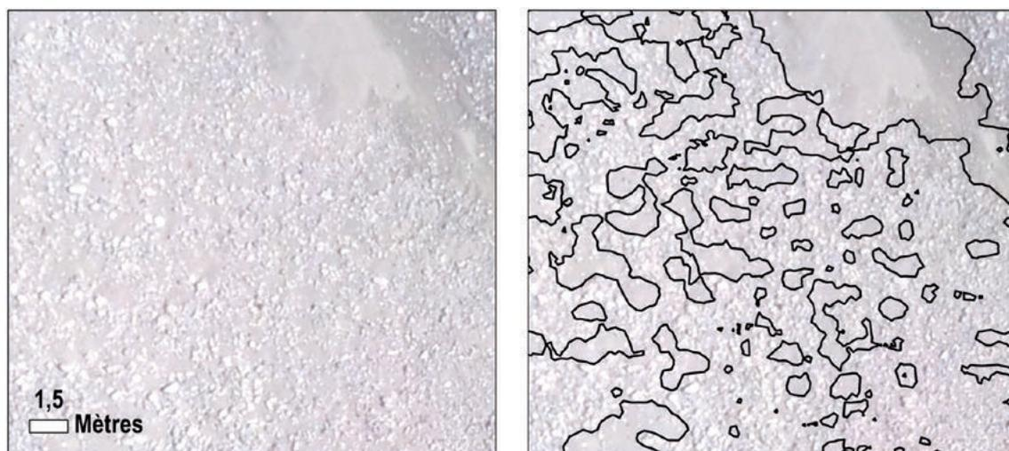
Figure 4. Segmentation d'image réalisée sur les orthophotographies aériennes et délimitation des patches sableux.
