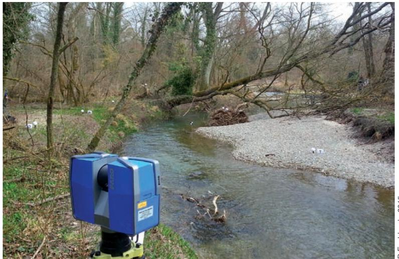
Figure 2. Acquisition lasergrammétrique (Faro focus 3D) sur le tronçon C.
