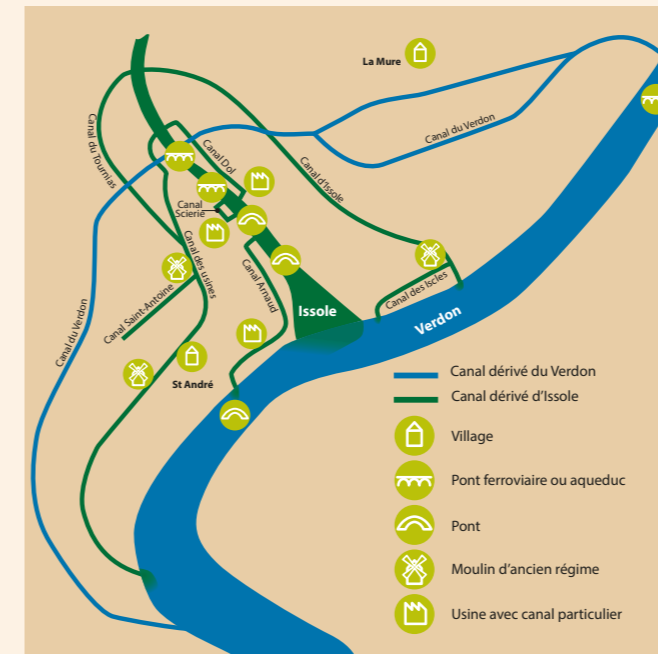
Plan des canaux ayant leur prise dans l'Issole en 1919. On voit le canal du Verdon qui traverse la rivière.
