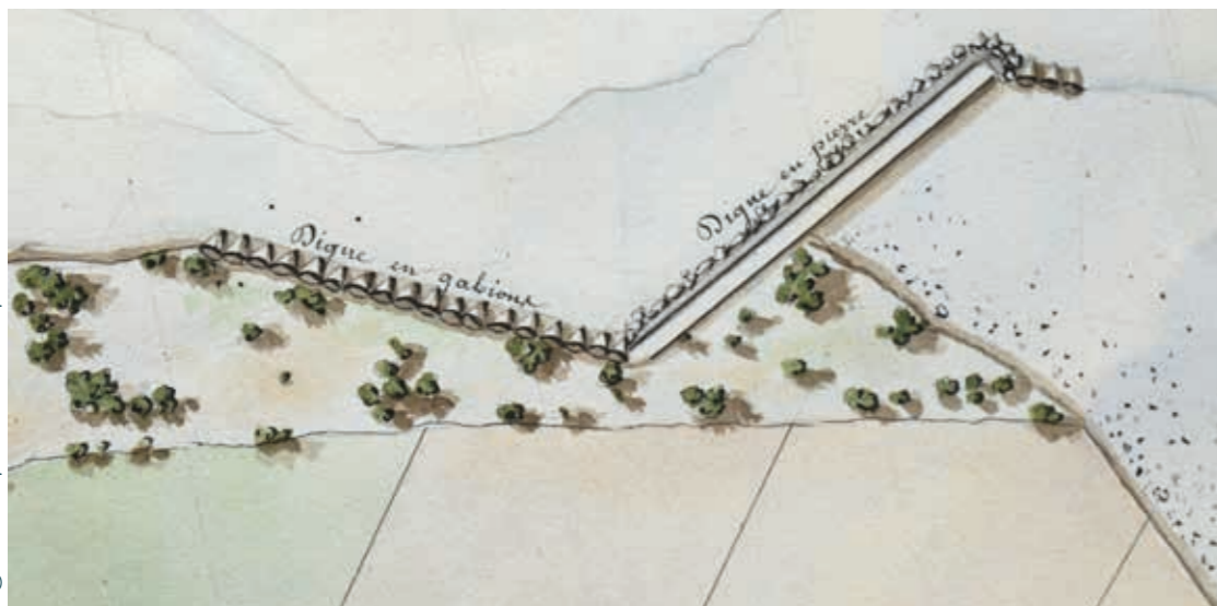
Digue en gabions et digue en pierre au niveau du confluent entre l'Issole et le Verdon, représentés sur un plan de 1851.
