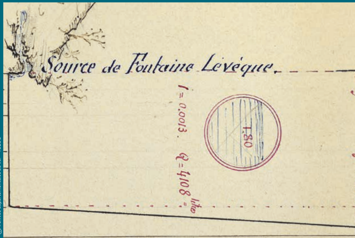
Détail du profil en long de l'avant-projet de dérivation de Fontaine-l'Évêque, 1896.
