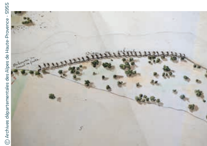
Dessin d'une digue en gabions, 1851.
