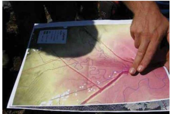
Figure 5 - La rectification de la Lemme datant de plus de 200 ans, ses anciens méandres n'étaient plus visibles dans le marais. Le tracé retenu a été défini grâce à un relevé topographique de haute précision. Quelques mesures topographiques complémentaires ont été nécessaires lors du piquetage sur le terrain (© PNR du Haut-Jura)
