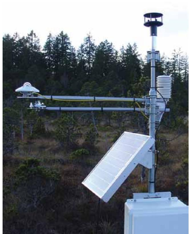
Photo 3 - Station météo équipée de capteurs de rayonnement à gauche (© BERNARD G.)
