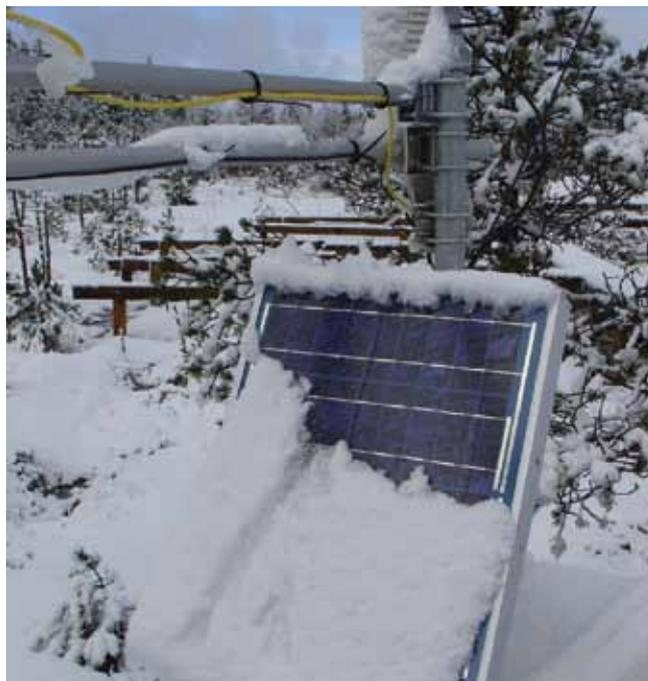
Photo 4 - pour le dimensionnement du système d'alimentation électrique, il faut prendre en compte l'enneigement qui peut limiter les performances du panneau solaire.
