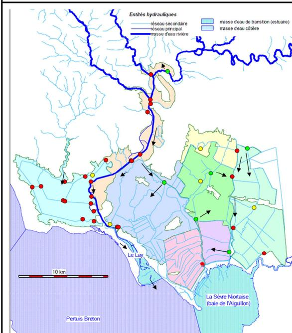
Cartographie surfacique des UHC de niveau 1 (surfaces colorées), des ouvrages (points colorés selon type), et des sens d'écoulements
