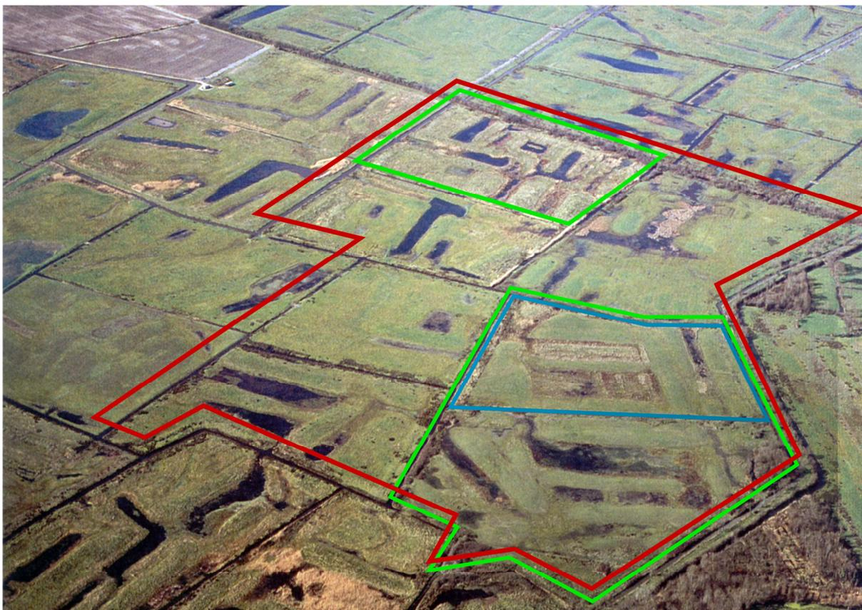
*Figure 3 : Exemple générique d'emboîtement d'UHC dans les marais atlantiques. Rouge : UHC de niveau 1, Vert : UHC de niveau 2, Bleu : UHC de niveau 3. Chaque niveau est sous dépendance hydraulique du niveau supérieur. L'UHC niveau 1 est elle-même sous dépendance du régime ou de la gestion du cours d'eau qui parcourt la bordure Nord (Photo FMA). (L.ANRAS, 2020)*
