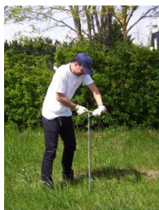
Schéma de principe de la pose d'un test de perméabilité (méthode Porchet)
